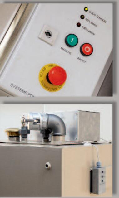
Après le test des huiles de friture, lorsque l'huile est froide, il vous suffit de mettre le système automatique en fonctionnement. Vous plongez la canne directement dans la cuve de la friteuse. L'huile est alors transférée vers une cuve centrale
